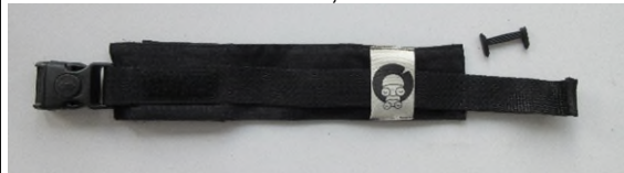
Bruch der Schnalle bei 1,6kN.
