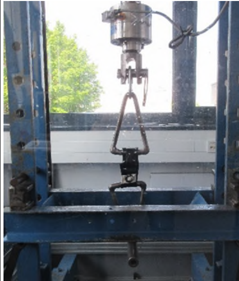
Bruch der Schnalle bei 1,6kN.
